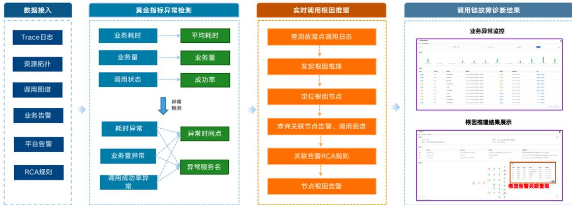
图8-9 调用链故障诊断实现流程
